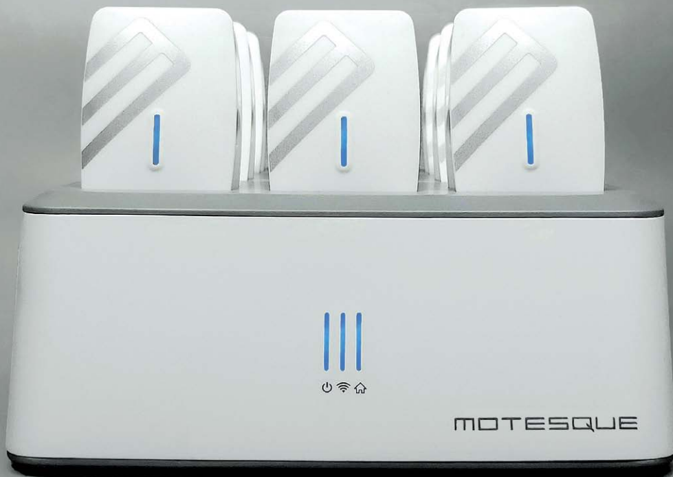
Kernstück des Bewegungsanalyse-Systems von Motesque: die Base Station, hier noch in der bisherigen Einplatinen-Version
